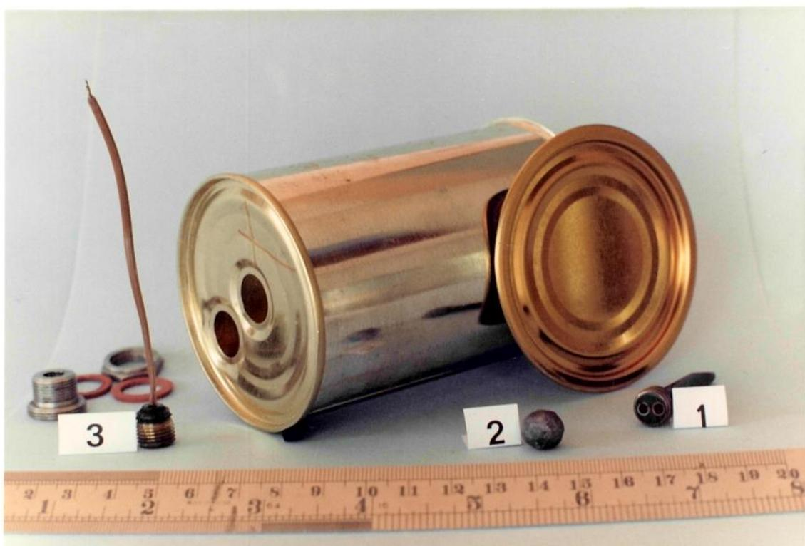
FIGURA 4.4. Detalhes da montagem do ensaio com dois termopares, o rígido (1), o flexível (3) e a esfera de chumbo (2), ambos colocados no fundo da lata.
