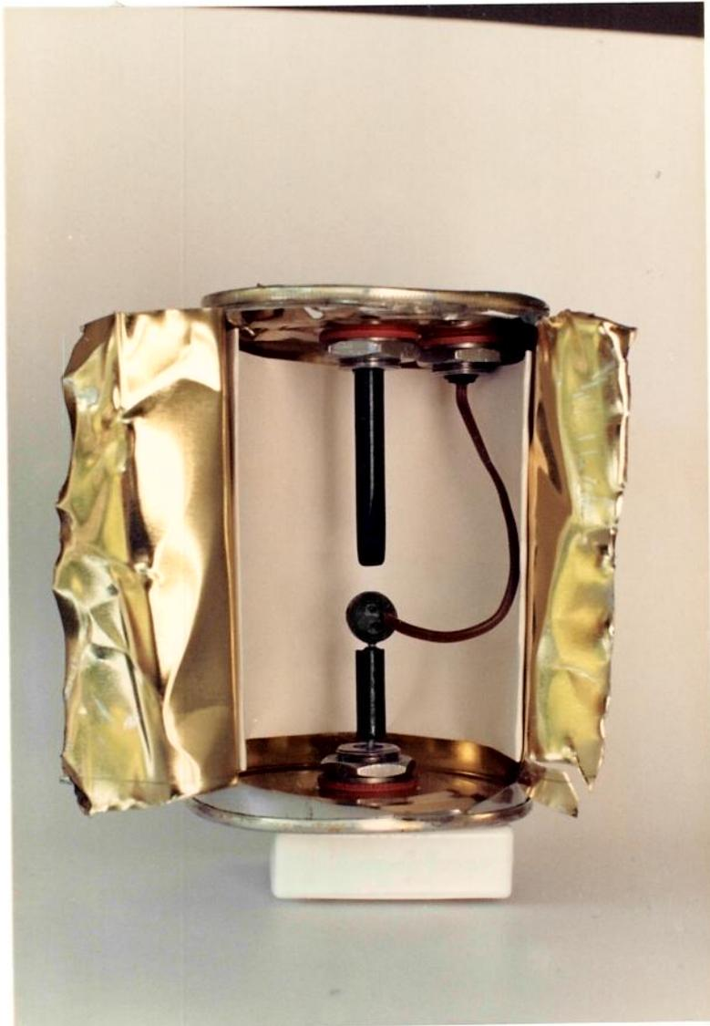
FIGURA 4.5. Detalhe do dispositivo interno, para fixar a esfera de chumbo, presa ao termopar flexível no centro da lata.
