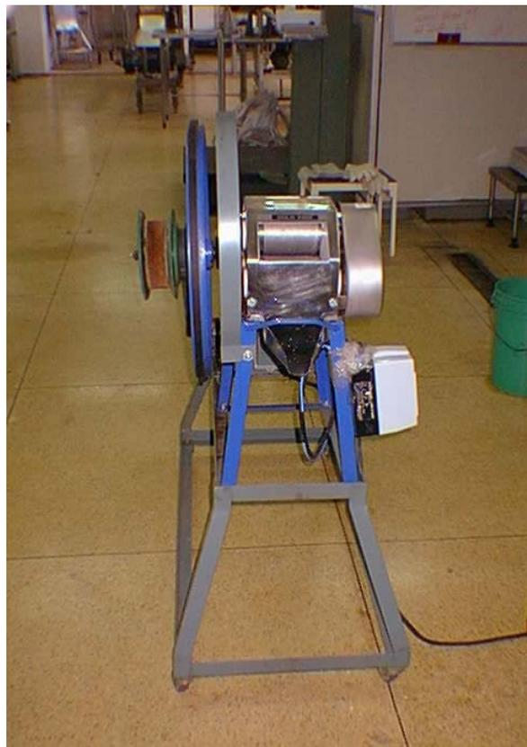
**APÊNDICE Q** - Máquina de envase utilizada no enchimento à quente do caldo de cana.
