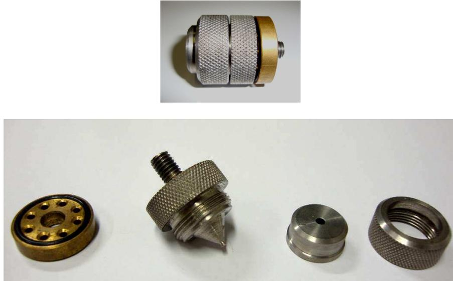
**Figura 4.4** - Bico atomizador com diâmetro de abertura de 1,0 mm e as partes que o compõem, empregado na atomização do material lipídico por *spray cooling* e no leito vibrofluidizado.
