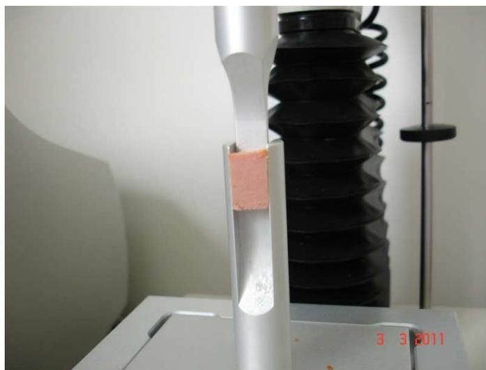
**Figura 4.** Análise de textura utilizando o *probe* Volodkevich Bite Jaws (HDP/VB).
