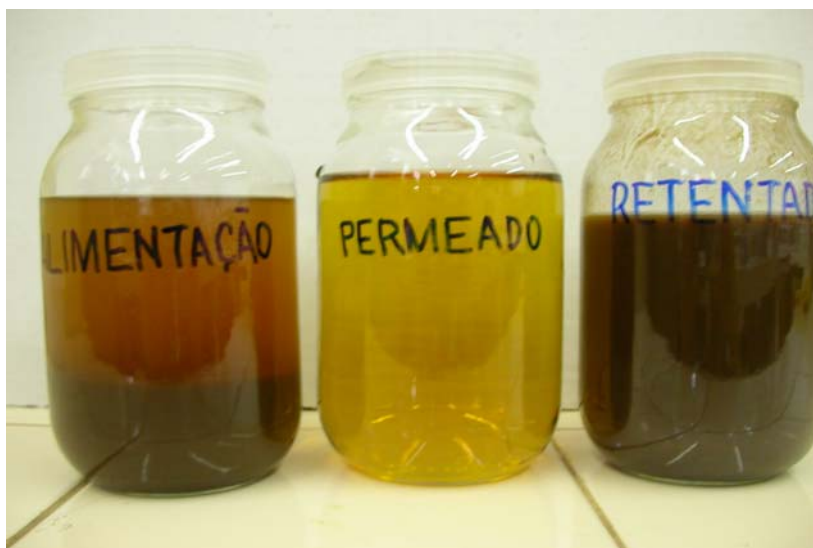
Figura 5.1. Imagem do produto inicial (alimentação) e dos produtos finais (permeado e retentado) dos experimentos de microfiltração.
