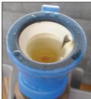
**Figura 2.3** – Frasco Lavador revelando depósito de areia junto ao fundo
