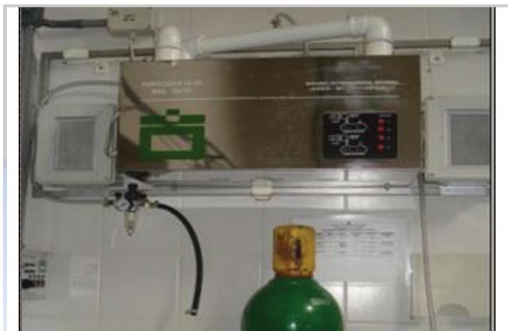
**Figura 3.1** – Equipamento gerador de Ozônio fabricado pela empresa Interozone.
