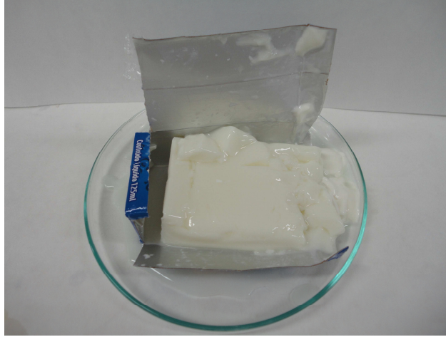
Figura 18: Amostra de leite UHT gelificada após 180 dias de armazenamento.
