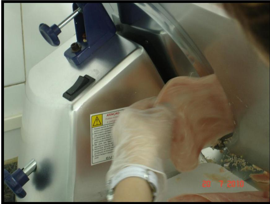
Figura 35. Fatiamento das amostras no fatiador para avaliação de fatiabilidade
