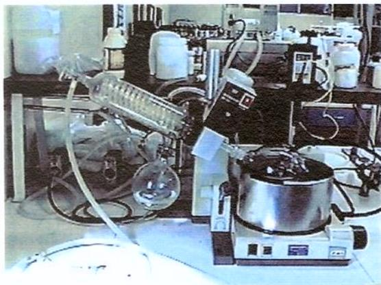
**FIGURA 5** – Concentração do xarope através de um rota evaporador.
