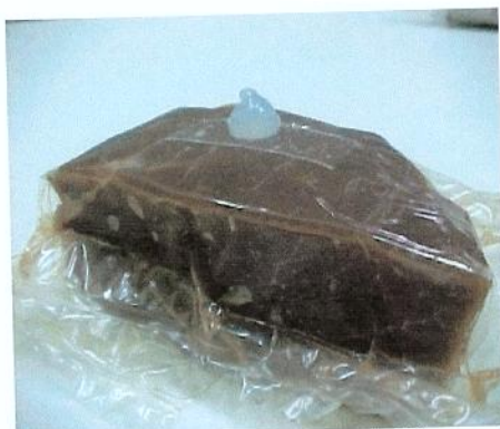
Figura 6 – Septo de silicone colado na região central da embalagem.
