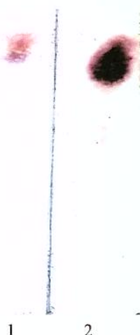
Figura 7.40: Placa cromatográfica (1: padrão voacangina; 2: amostra 3 do experimento 20)
