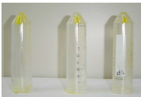
Figura 5.23: Fotografia das ceras obtidas através do óleo bruto processado por ultrafiltração e centrifugado após o teste de frio.
