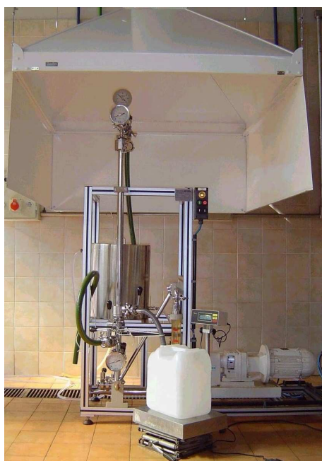
Figura 4.2: Fotografia da unidade piloto de ultrafiltração utilizada.
