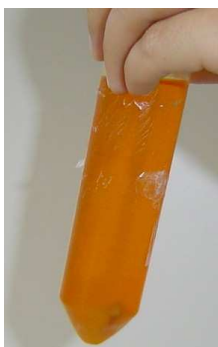
Figura 5.22: Fotografia do óleo bruto centrifugado após o teste de frio.
