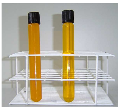
Figura 5.21: Fotografia do óleo bruto de milho e do óleo bruto de milho processado por ultrafiltração.
