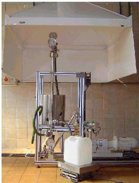
**Figura 1** – Unidade piloto de ultrafiltração NETZSCH
