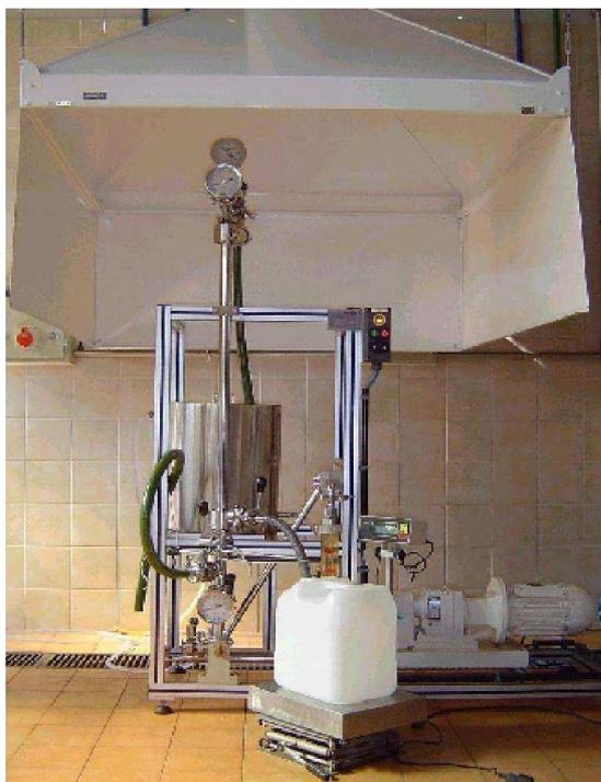
**Figura 2** – Unidade piloto de ultrafiltração netzsch.
