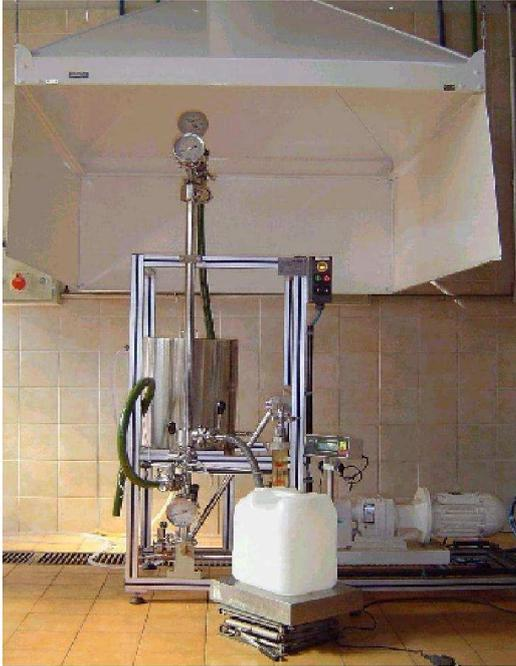
**Figura 1** – unidade piloto de ultrafiltração NETZSCH.
