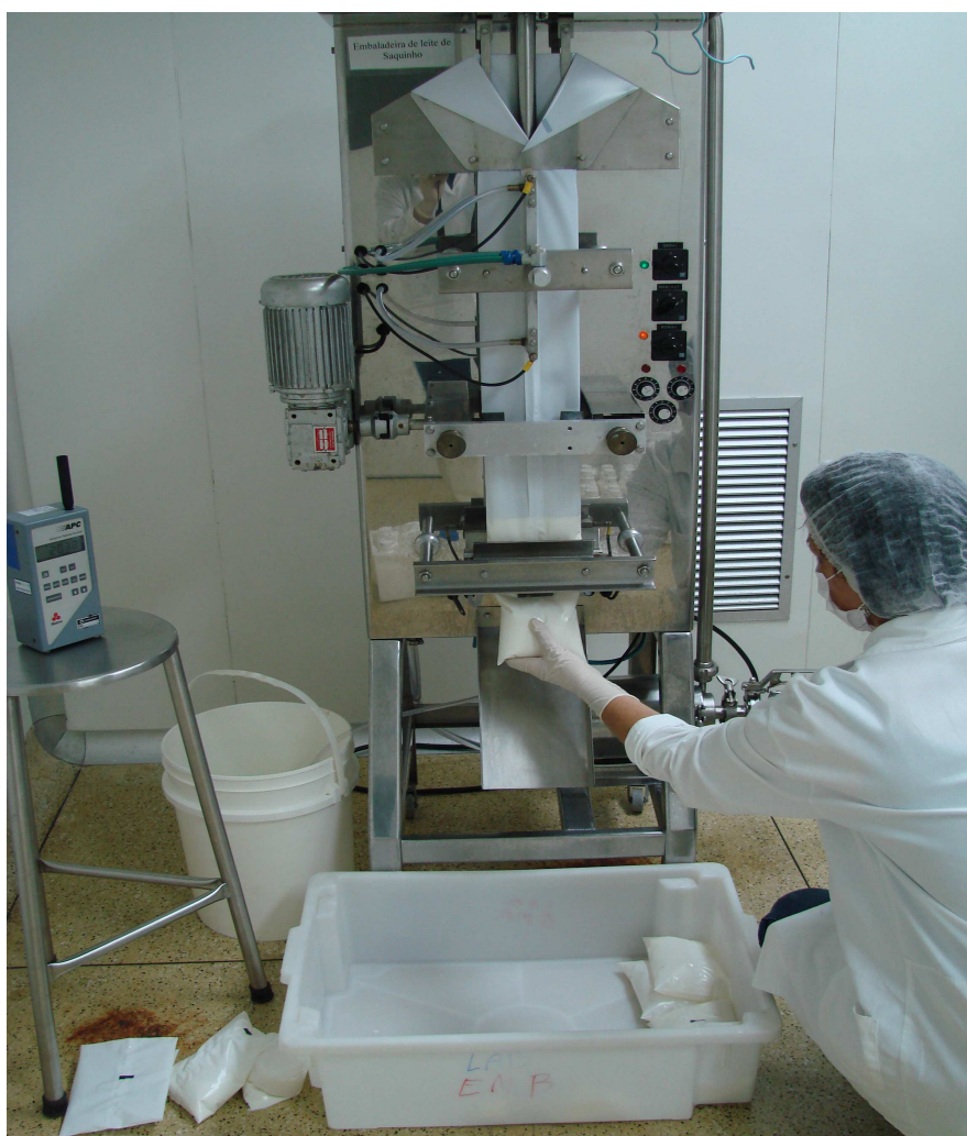
Figura 4. Acondicionamento do leite em saquinhos de PEBD, na sala limpa.
