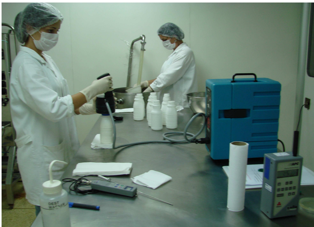
Figura 3. Envase e fechamento das garrafas de PEAD, na sala limpa.
