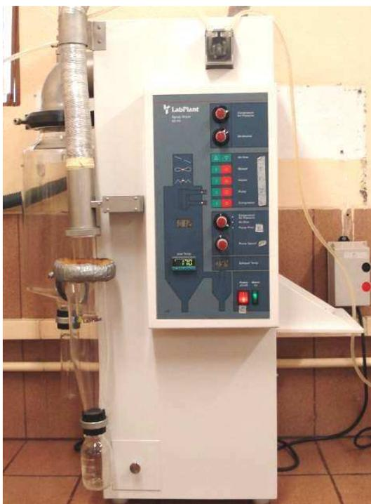
Figura 4.2 - *Spray dryer* utilizado nos ensaios de secagem.
