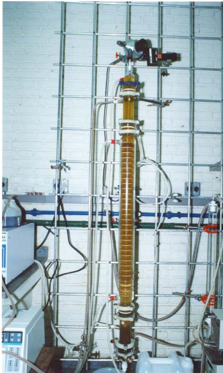
**Figura 1.3.** Coluna de extração líquido-líquido (PRDC) existente no LASEFI.
