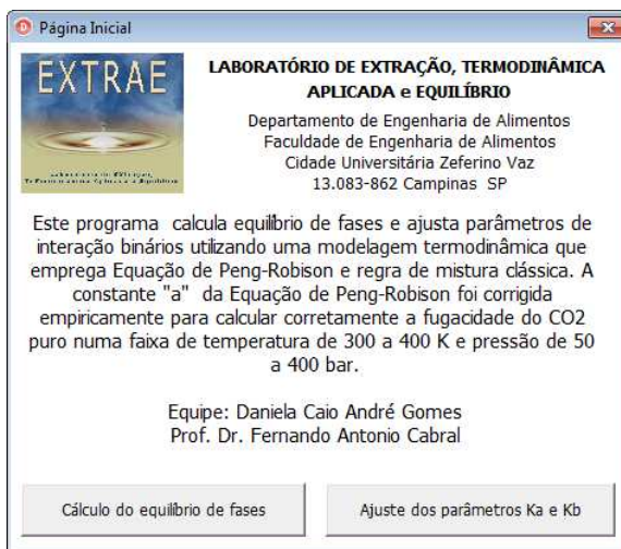
Figura 3.6 Interface do programa desenvolvido para calcular o equilíbrio de fases e o ajuste dos parâmetros K_a e K_b , com a correção do parâmetro a proposta neste trabalho.
