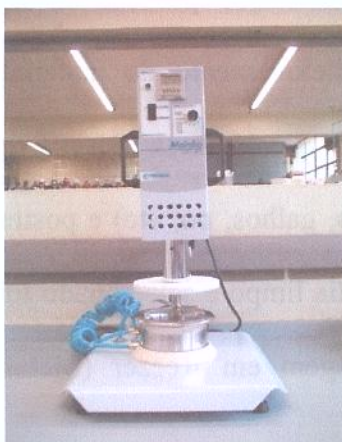
Figura 3.1. Moinho de laboratório Tecnal modelo TE631/1.
