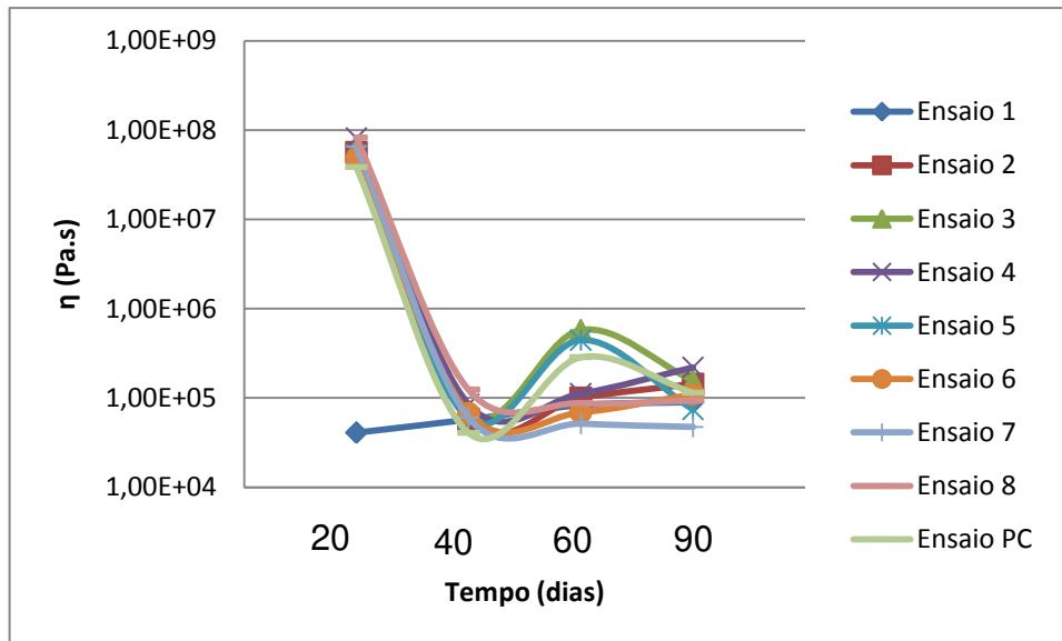
Figura 55. Evolução da viscosidade newtoniana (Pa.s) durante os 90 dias de armazenamento refrigerado.
