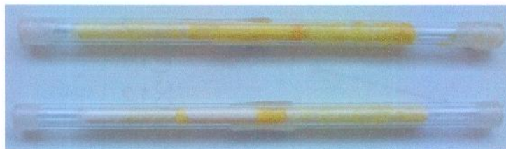
Figura 4-16. Adsorvente do tipo Porapak Q utilizado na saída do sistema de ESC para EtOH/IsoC3 à alta e baixa porcentagem de co-solvente, respectivamente.
