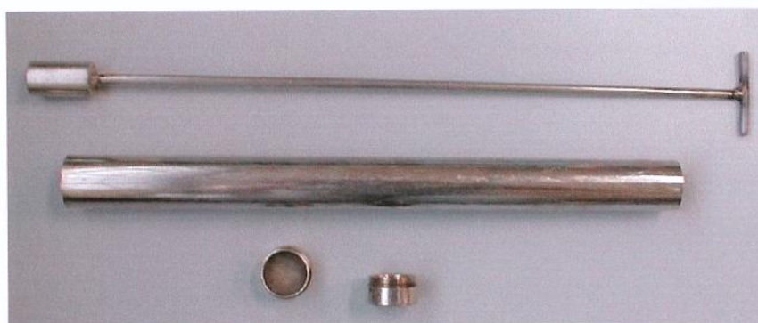
Figura 3-2. Célula extratora e socador utilizado para empacotar o leito.
