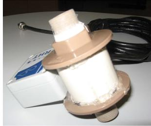
Figura 4.8 - Adaptação para instalação do sensor de temperatura e umidade RHT-WM.
