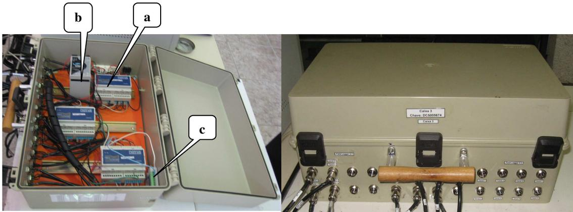
Figura 4.7 - Sistema de aquisição de dados (vista interna e externa, respectivamente): (a) Field Logger; (b) Fonte de alimentação; (c) conversor.
