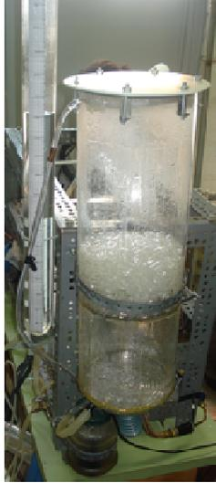
Figura 4.4 - Câmara de umidificação com recheio de vidro.
