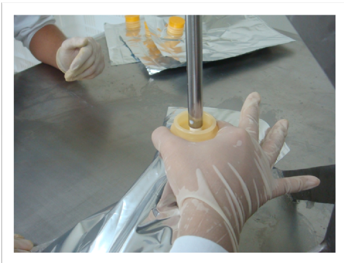
Figura 23- Posicionamento do bico da envasadora no bocal da embalagem durante o enchimento.
