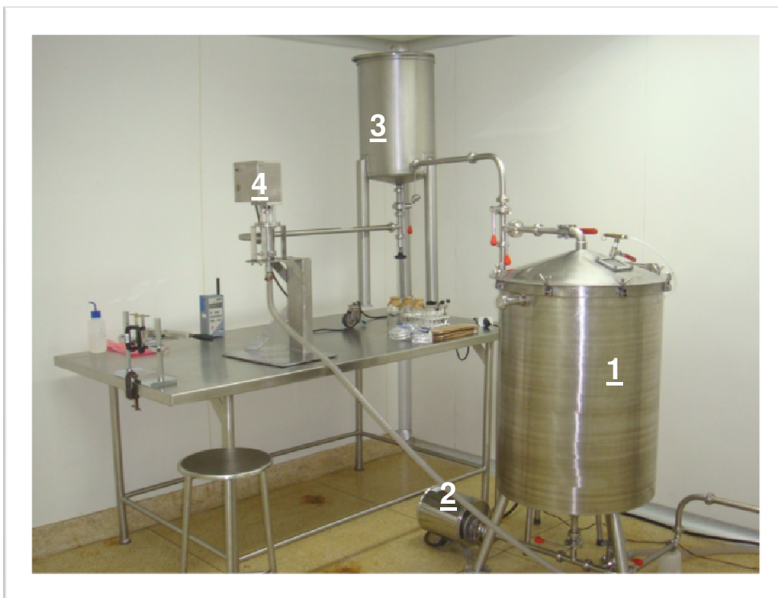
Figura 13- Detalhes do enchimento asséptico dos bags , montado na sala limpa da Planta Piloto do DTA/FEA: (1. tanque asséptico; 2. bomba centrífuga; 3. tanque de equilíbrio; 4. dosadeira).
