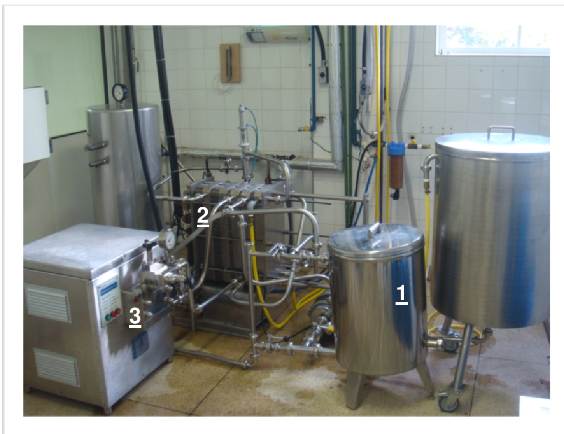
Figura 12- Linha de processamento UHT do DTA/FEA (1. tanque de matéria-prima; 2. trocador de calor; 3. homogeneizador).
