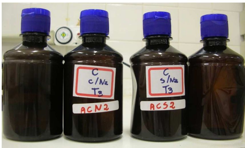
Figura 6. Colapso das embalagens não inertizadas com nitrogênio (as duas garrafas à direita).
