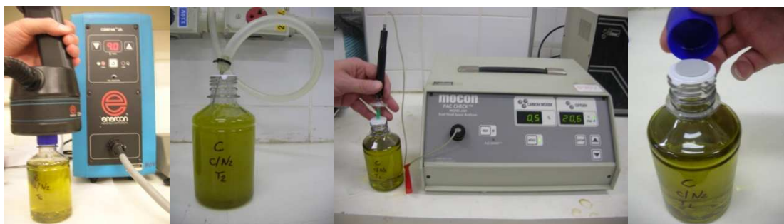
Figura 2. Processo manual de selagem, injeção de nitrogênio, medida de oxigênio no headspace e fechamento com septo e tampa.
