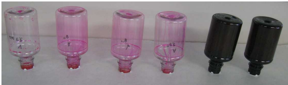
Figura 7. Teste de integridade da selagem das embalagens de PET.
