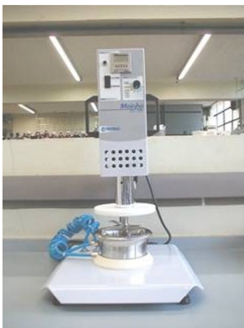
Figura 3.1 - Moinho de laboratório Tecnal modelo TE631/1
