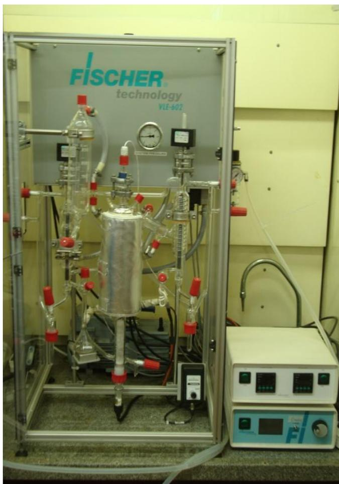
Figura 1A - Ebulliômetro de Recirculação
