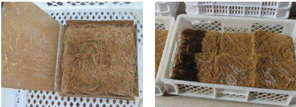
Figura 14 - Processo de secagem das mantas de fibra de coco.
