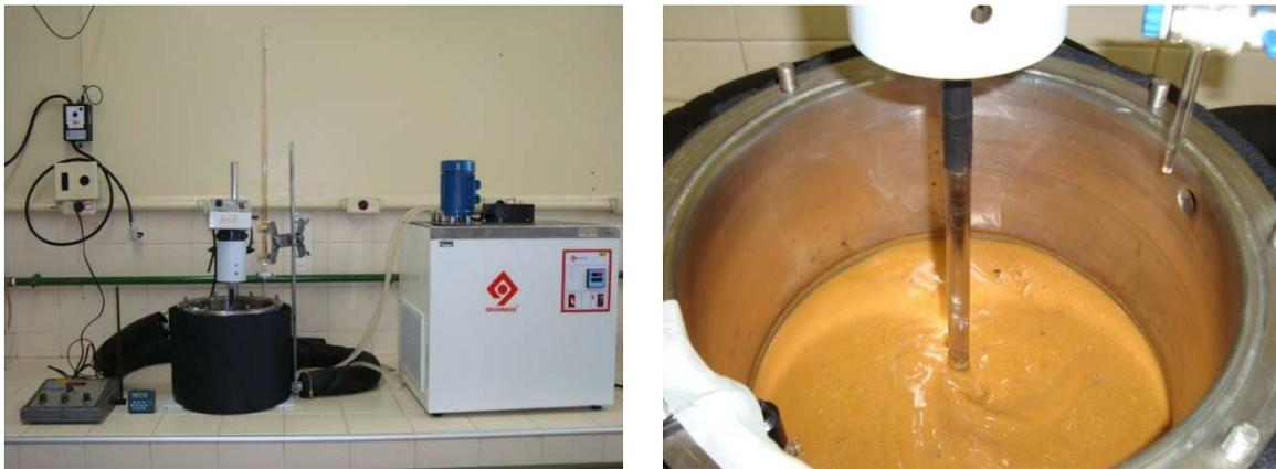
**Figura 4.2.** Montagem experimental para a hidrólise enzimática da carne de mexilhão, reator de 7 L.
