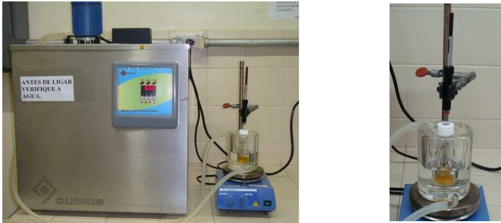
**Figura 4.3.** Montagem experimental utilizada para a extração dos compostos voláteis através da microextração por fase sólida (SPME).
