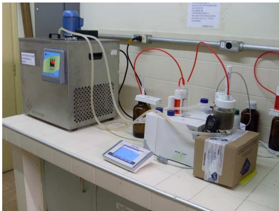
Figura 3.2. Sistema montado para a hidrólise enzimática de pele de cão
