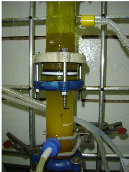
**Figura 5.10.** PRDC durante o experimento de desacidificação de óleo de soja degomado.
