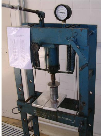
Figura 4.6. Prensa hidráulica.
