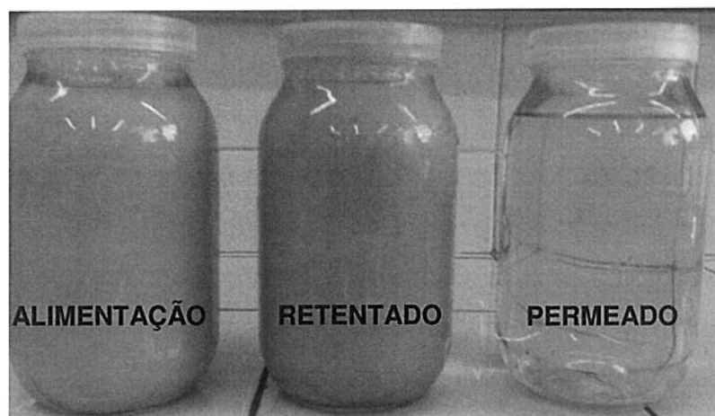
Figura 5.1: Fotografias da alimentação e dos produtos obtidos (retentado e permeado).
