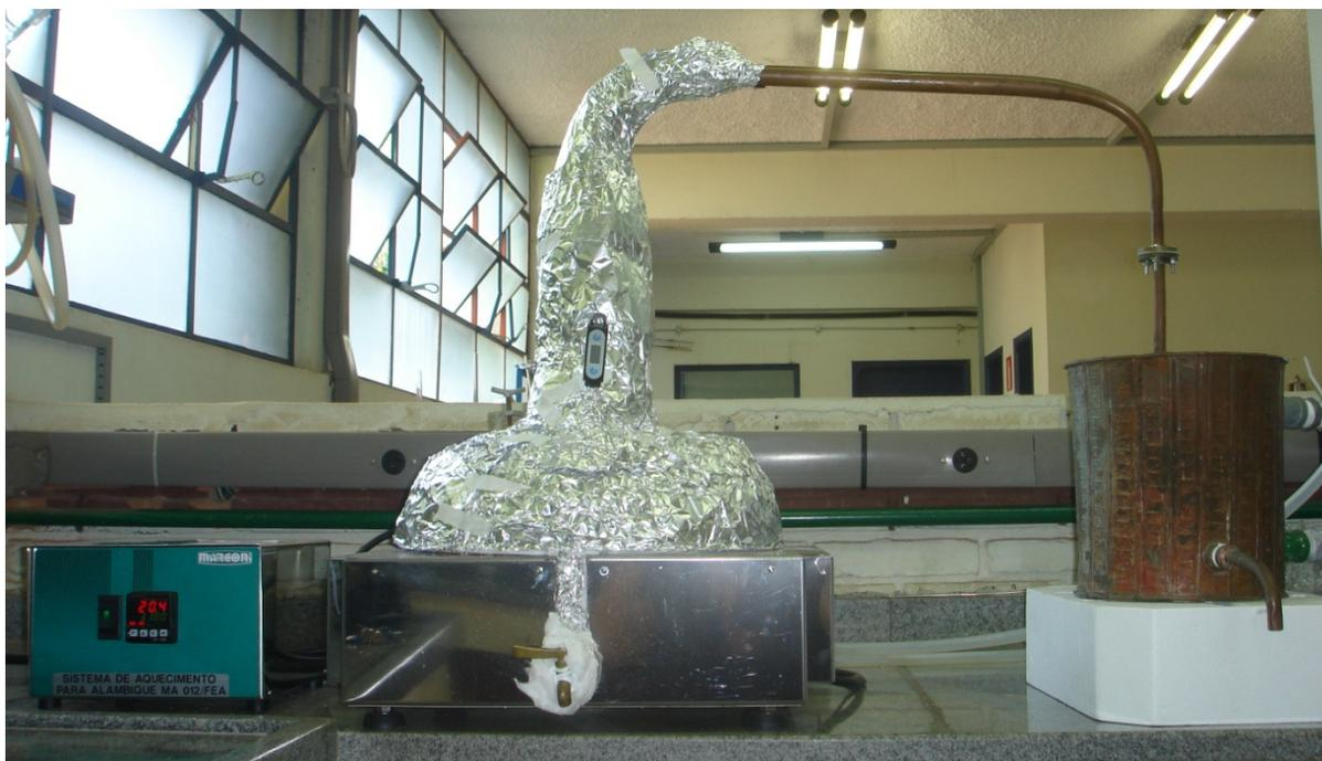
**Figura 6 - Alambique simples termicamente isolado e sistema de aquecimento.**
