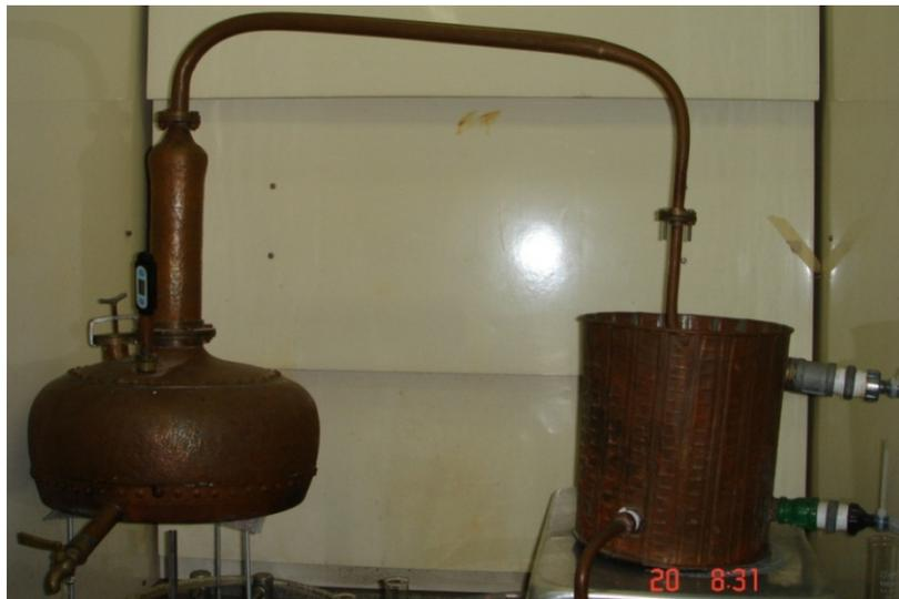
**Figura 5 – Esquema do alambique em escala laboratorial.**
