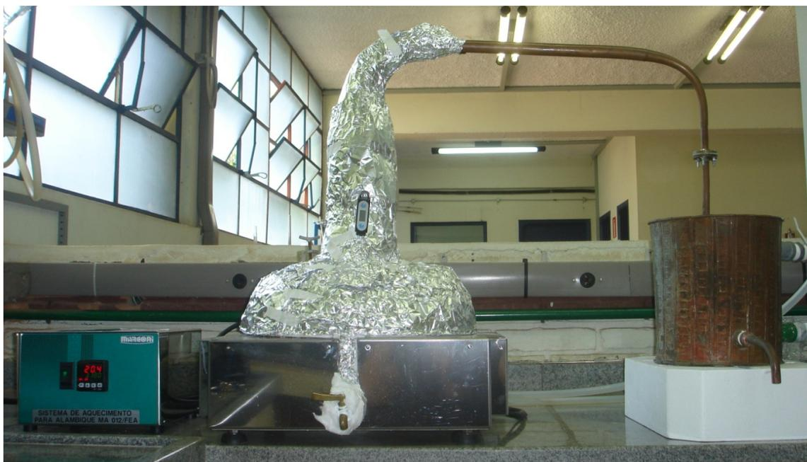
**Figura 16 - Alambique simples termicamente isolado e sistema de aquecimento.**
