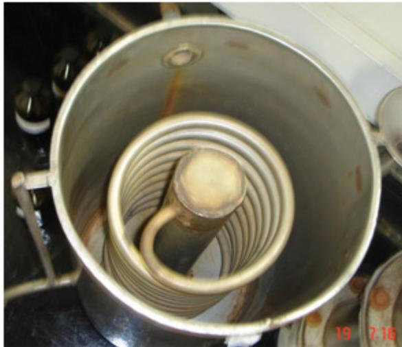
**Figura 36 - Condensador com cilindro interior, que gera refluxo natural.**
