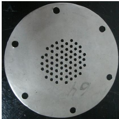
**Figura 71 – Prato da coluna retificadora no alambique modificado.**
