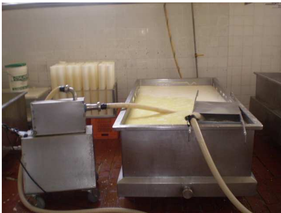
Figura 13. Tanque de recepção do soro com a bomba de transferência de soro.
