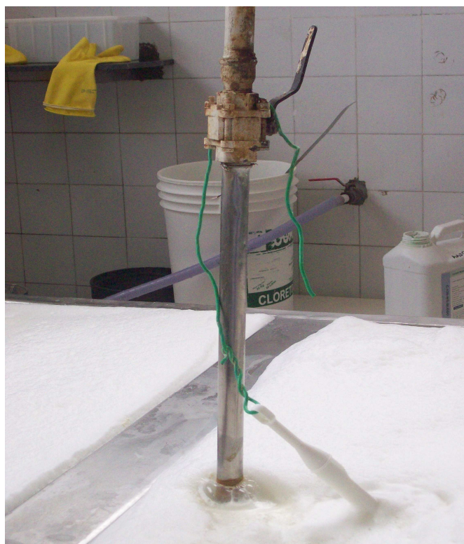
Figura 15. Aquecimento do produto com vapor direto.
