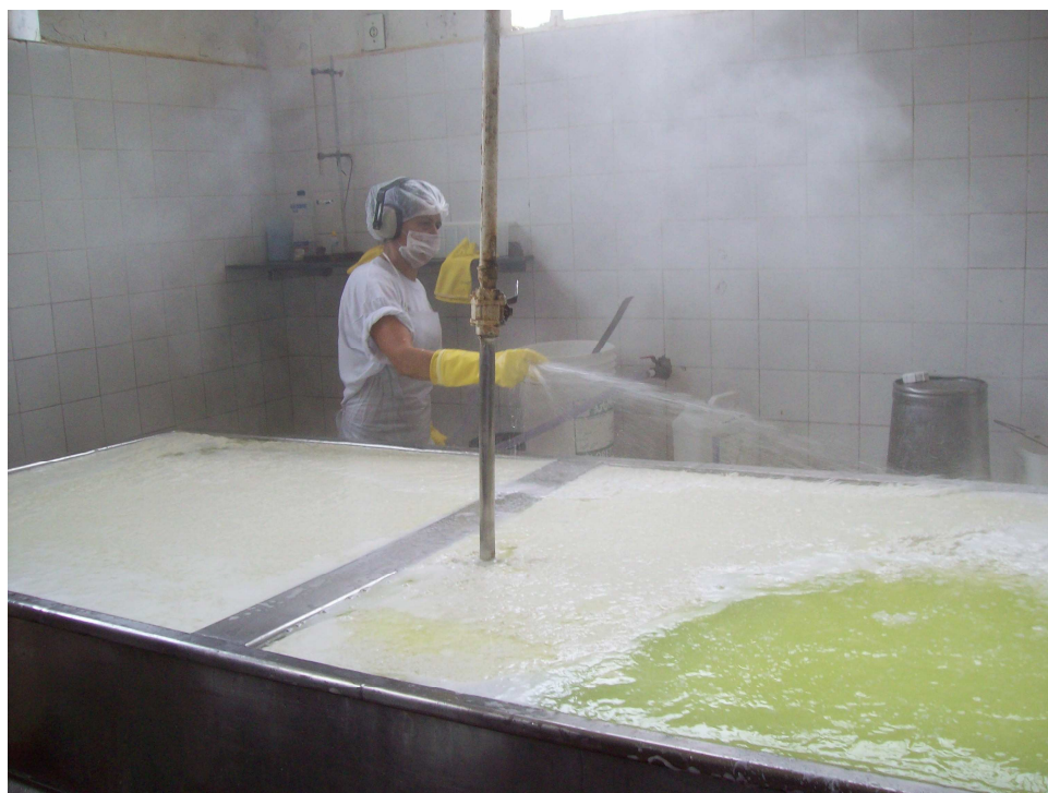
Figura 16. Retirada da espuma com jatos de água.
