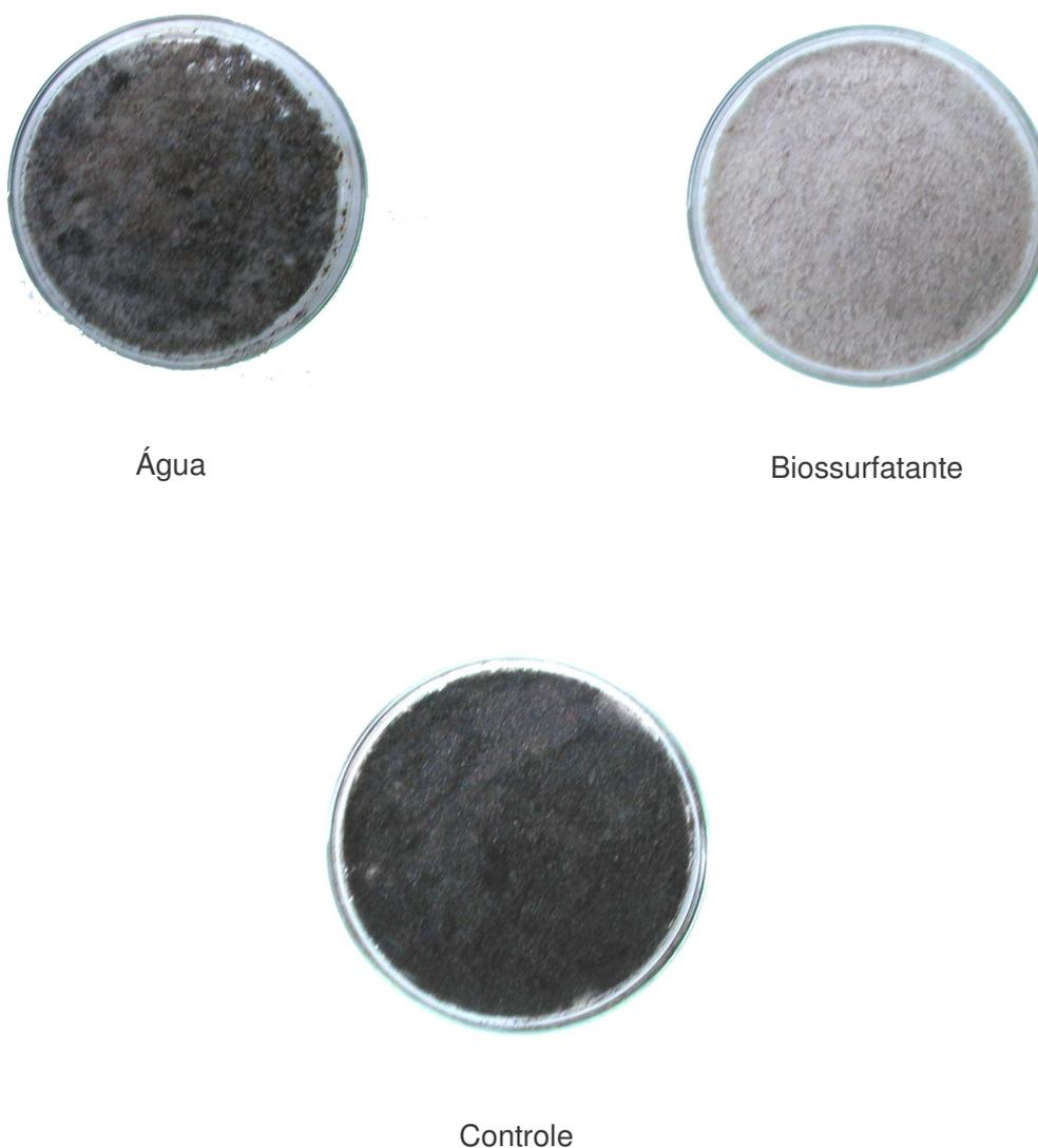
Figura 20. Capacidade de remoção de petróleo de amostra de areia utilizando solução de biossurfatante produzido por *B. subtilis* LB5a em manipueira.
