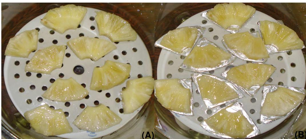
**Figura 3.7.** Etapas da análise de resistência ao vapor de água: (A) amostras em dessecador mantido a UR 98,5%, (B) amostras sobre suporte em dessecador mantido a UR 32,7%.
