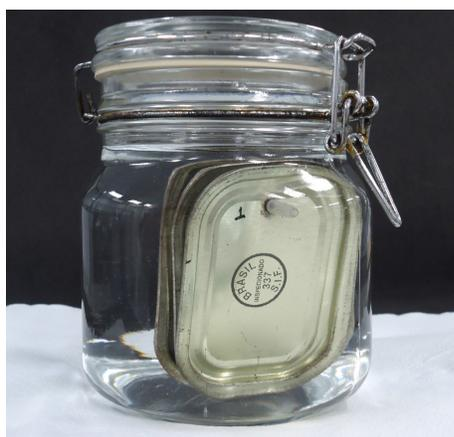
Figura 4.2. Fotografias ilustrando o risco realizado (a), a preparação das tampas para a realização do ensaio (b) e o pote hermético utilizado como célula no ensaio de avaliação da resistência à sulfuração com simulante (c).
