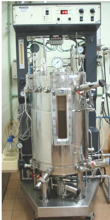
Figura 12: Fermentador de 100 litros New Brunswick modelo Mobile Pilot Plant Fermentor.
