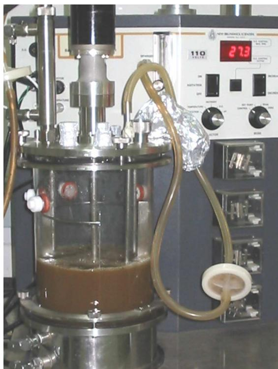
Figura 6: Fermentador de bancada de 6,6 litros New Brunswick Bioflo IIc.
