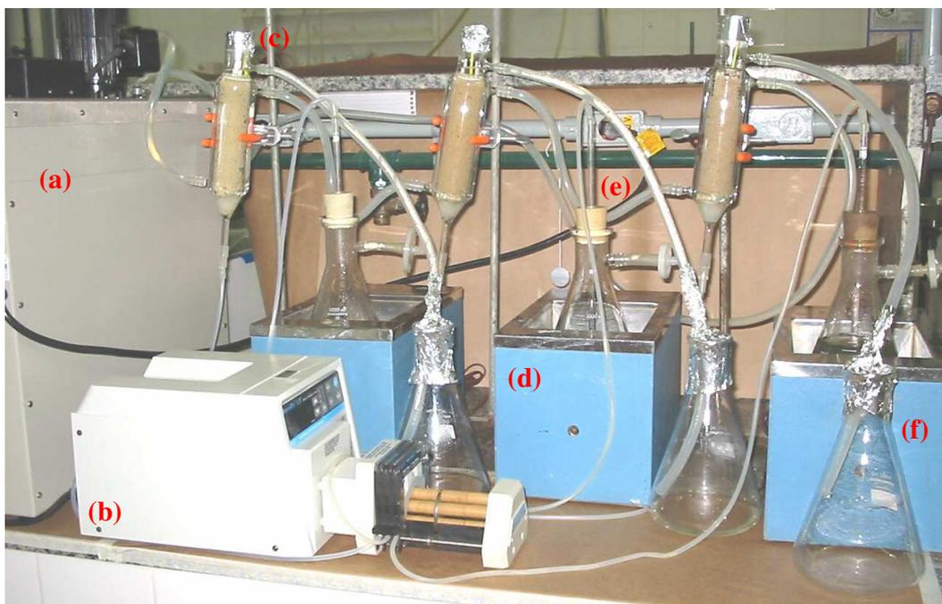
Figura 9: Produção de isomaltulose, a partir de sacarose, por células íntegras imobilizadas em colunas de leito empacotado.
