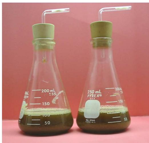
Figura 10: Frascos Erlenmeyers de 250 mL contendo 50 mL de meio de cultivo otimizado contendo água de maceração de milho fermentado por células de *Erwinia* sp. D12.
