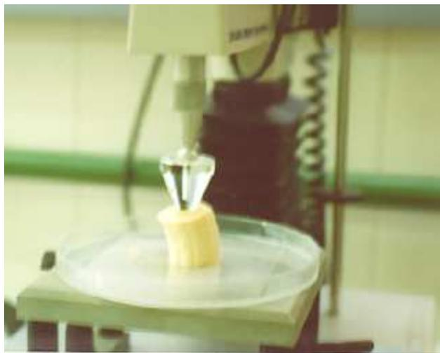
**Figura 5:** Obtenção da medida de dureza das bananas com o auxílio do aparelho Texturômetro TA-XT2.
