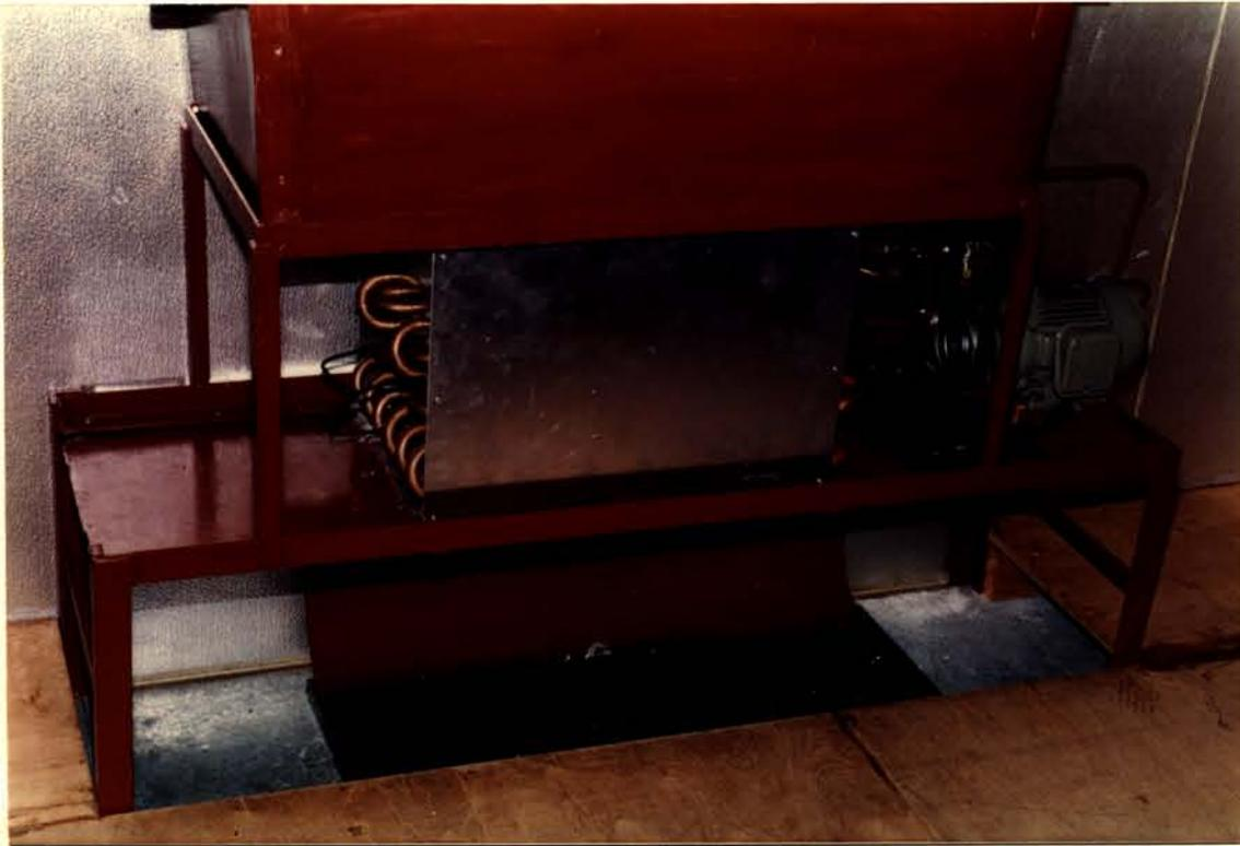
**Figura IV.2b-Detalhe da montagem do piso, vendo-se na base do evaporador a abertura para o retorno do ar das camisas.**
