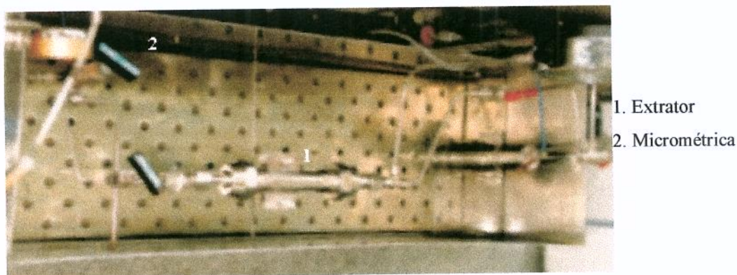
Figura 4.3. Extrator e válvula micrométrica em detalhe (Vista superior)
