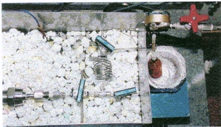
Figura 6.2. Sistema de coleta do óleo aromático de café torrado extraído com \text{CO}_2 supercrítico para o cálculo da solubilidade.
