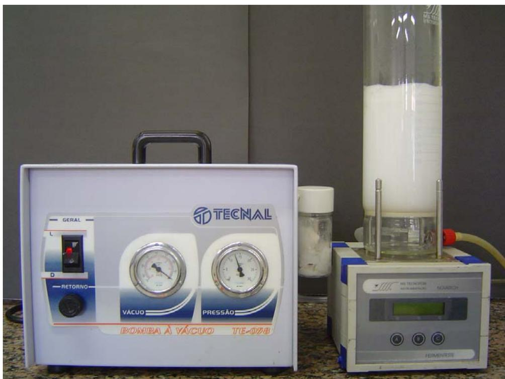
**Foto:** Sistema avaliação da eficiência de antiespumantes para fermentação (Fermenteste).
