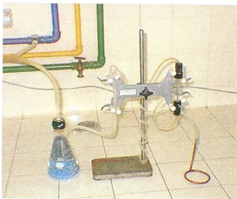
Figura 3.5. Sistema de aeração.
