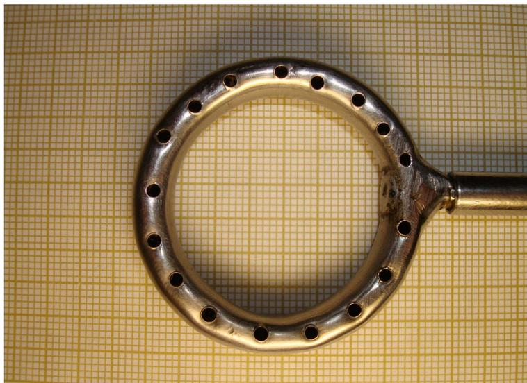
**Figura 3.** Distribuidor multiperfurado utilizado por Pina (2001):  $A_N = 52,38 \text{ mm}^2$ ,  $D_N = 1,98 \text{ mm}$ .
