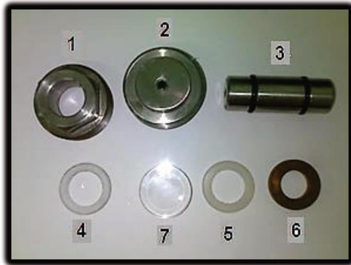
**Figura A14.** Componentes da célula de equilíbrio: 1- rosca frontal; 2 – rosca do fundo; 4,5 e 6 – o-rings; 7 – janela de safira.
