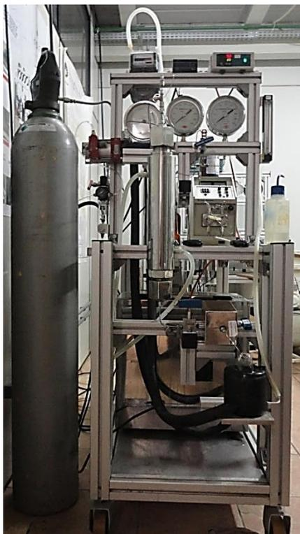
**Figura A2.** Unidade de extração SFE-I (Unidade cossolvente e/ou PLE).
