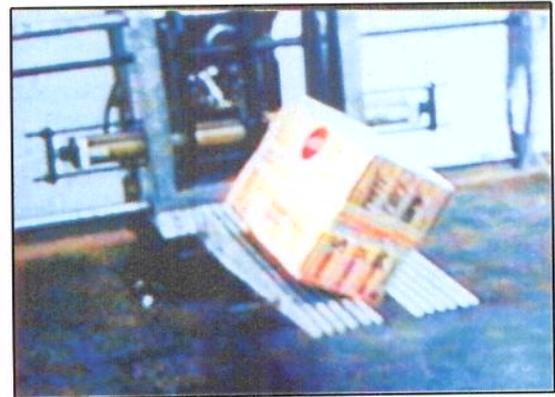
**FIGURA 16.** Impacto por queda livre com a borda 2-3 voltada para baixo.
