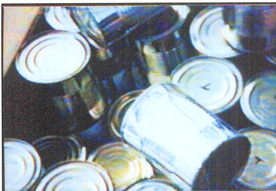
**FIGURA 20.** Foto das amostras convencionais após quatro impactos por queda livre ilustrando amassamento intenso (G3).
