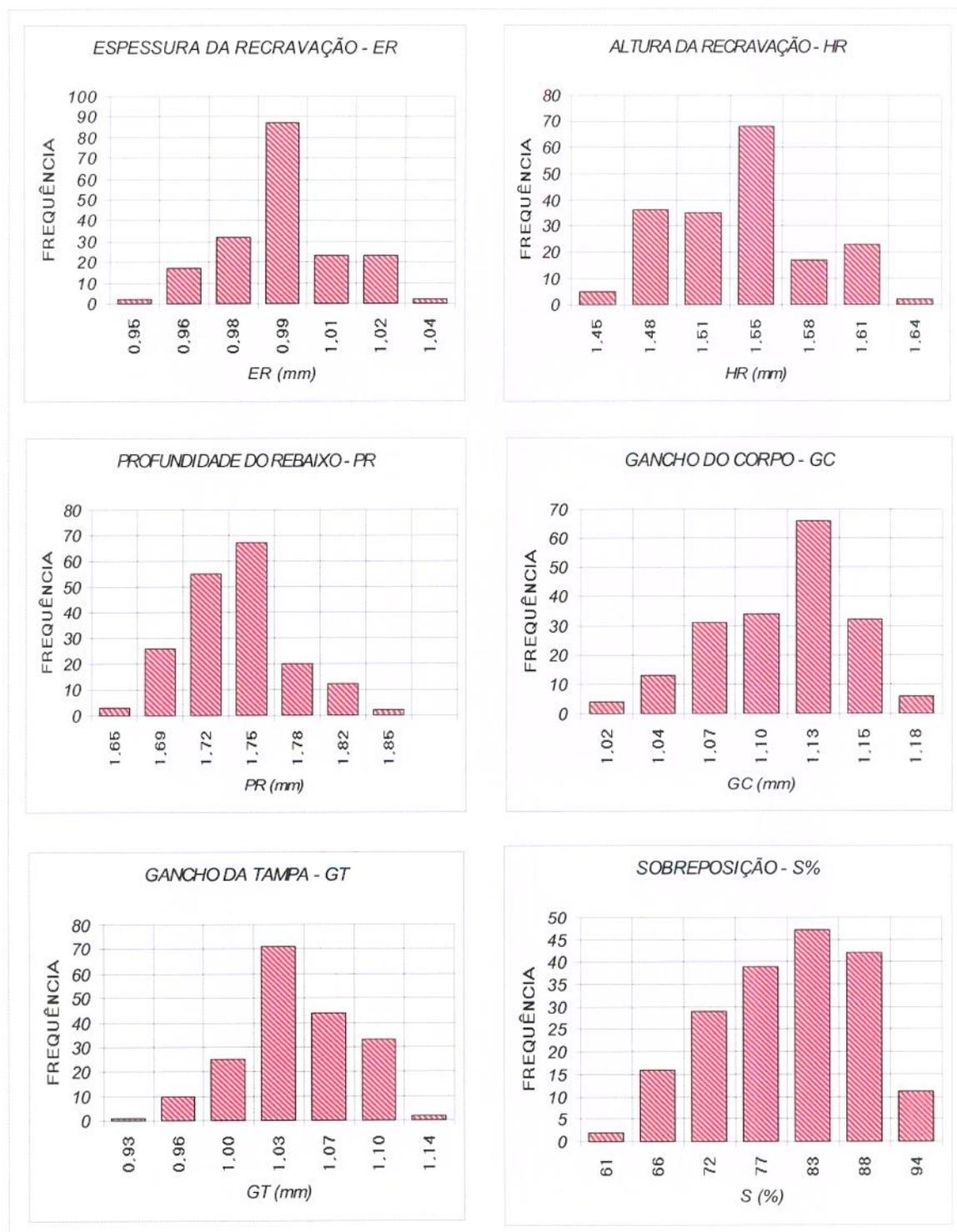
**FIGURA 21.** Parâmetros (ER;HR;PR;GC;GT e S) e frequência do exame de recravação, avaliados em 62 latas micro-recravadas acondicionadas com caldo lactosado.
