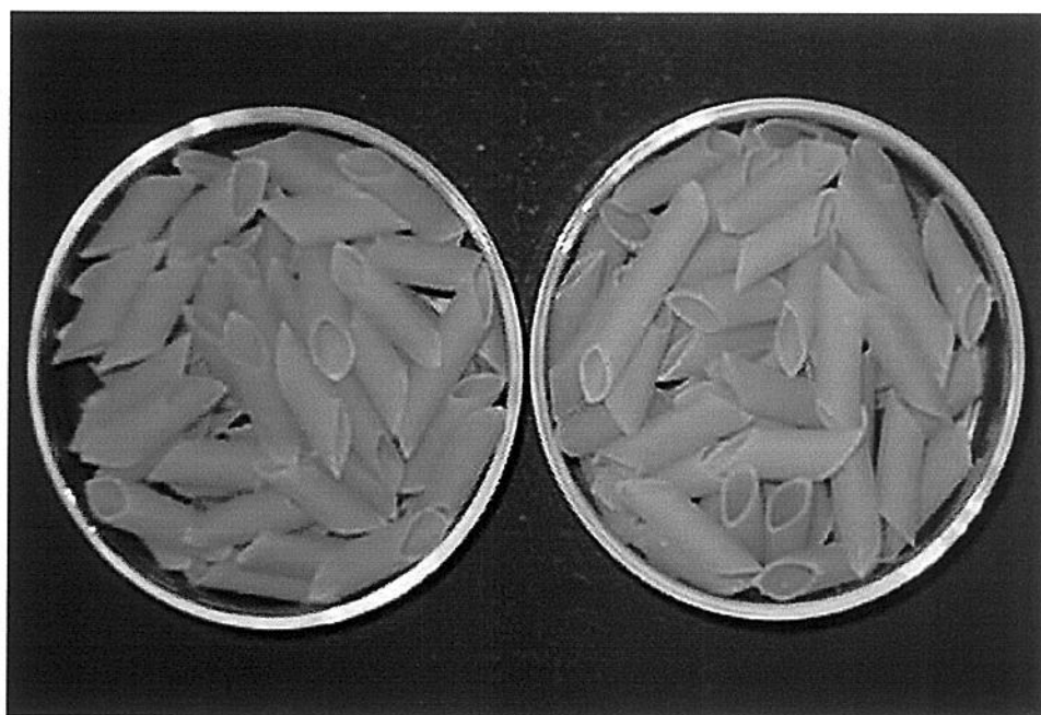
Figura 10: Referente ao teste dos pontos centrais , macarrão tipo Penne – trigo mole, seco a uma potência de 200W, vazão de 1,0\text{m}^3/\text{min} , tempo de 25 minutos. A esquerda tem-se o produto não equalizado e a direita tem-se o produto equalizado.
