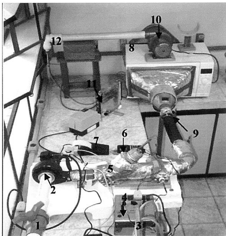
Figura 4: Forno de microondas doméstico adaptado a um sistema gerador de ar quente - (1) válvula de esfera; (2) ventilador centrífugo do ar de entrada; (3) manômetro “U”; (4) controlador de temperatura (5) aquecedor por resistência elétrica; (6) termômetro digital c/ termopar; (7) registrador de temperatura; (8) forno doméstico; (9) abraçadeira de conexão do forno com o sistema de ar quente; (10) ventilador centrífugo de exaustão; (11) medidor de vazão; (12) saída do ar.
