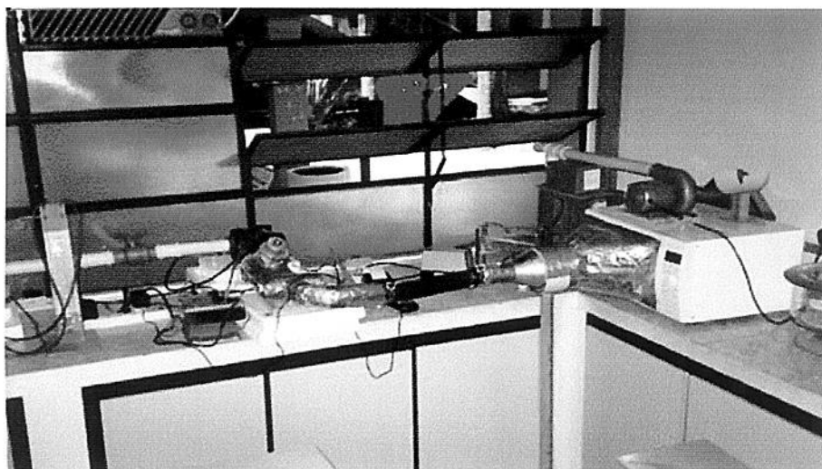
Figura 5: Forno de microondas doméstico adaptado,
