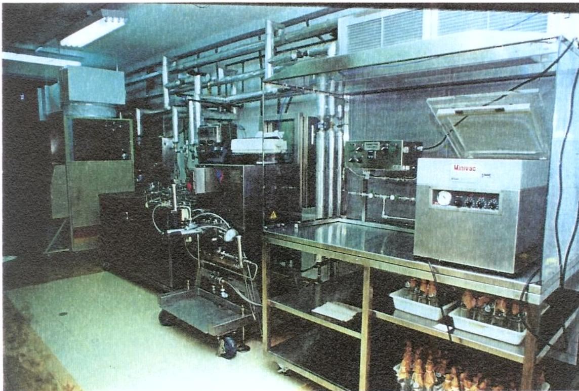
*Figura 20 – Unidade Asséptica UHT mostrando em primeiro plano capela de enchimento*
