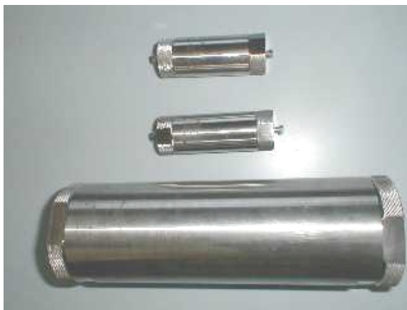
Figura 8. 55 Células de extração (Thar Designs, Pittsburg, PA, Estados Unidos) de 3, 5 e 300 mL.
