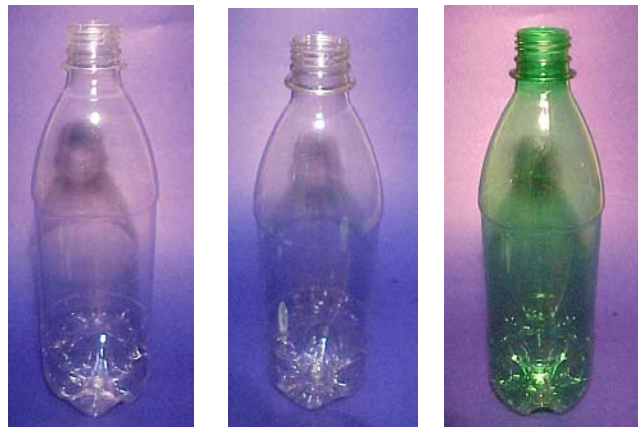
Figura 8 : Garrafas de PET de 600mL utilizadas no experimento: 23g, 25g e 28g.
