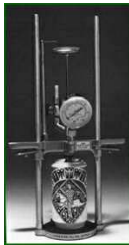
Figura 5: Ilustração do equipamento Zahn Nagel para medição da pressão interna das embalagens
