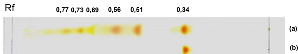
Figura 3.2.- Cromatografia de camada delgada (CCD) do extrato contendo carotenóides presentes no camarão rosa. (a) Extrato IPA: n-hexano. (b) Padrão puro de Astaxantina (>93%).
